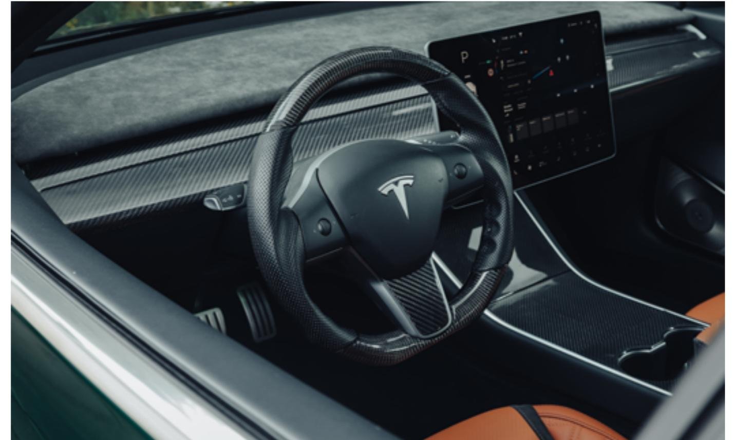
*Tesla 3 avec tableau de bord, volant et console centrale en carbone*
